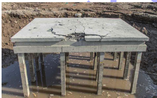
图4 水下爆炸下码头面层破坏现象
