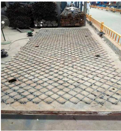
图6 免凿毛造型模板
