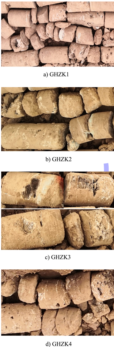
图 5 固结灌浆后 4 个检测孔岩芯
