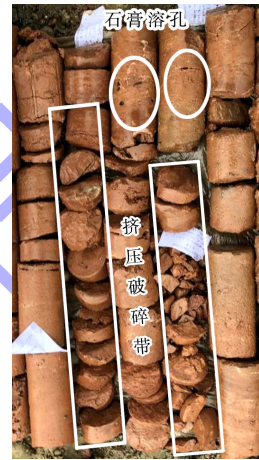
图 1 闸基岩体石膏溶蚀孔隙及挤压破碎带
