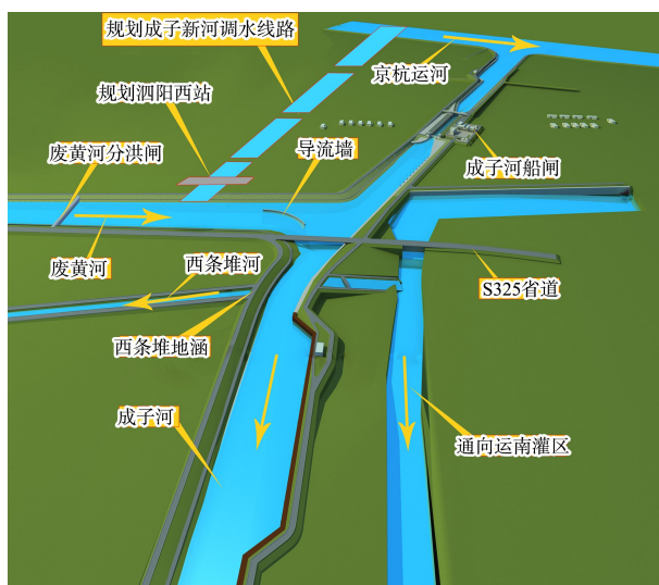
图2 成子河船闸工程总体布置
