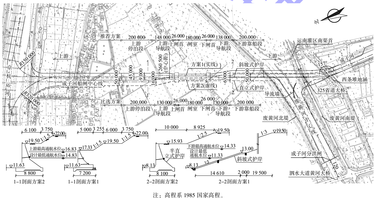
图5 成子河船闸平面布置方案 (高程: m; 尺寸: mm)
