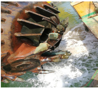
图 4 改进防石板绞刀结构
