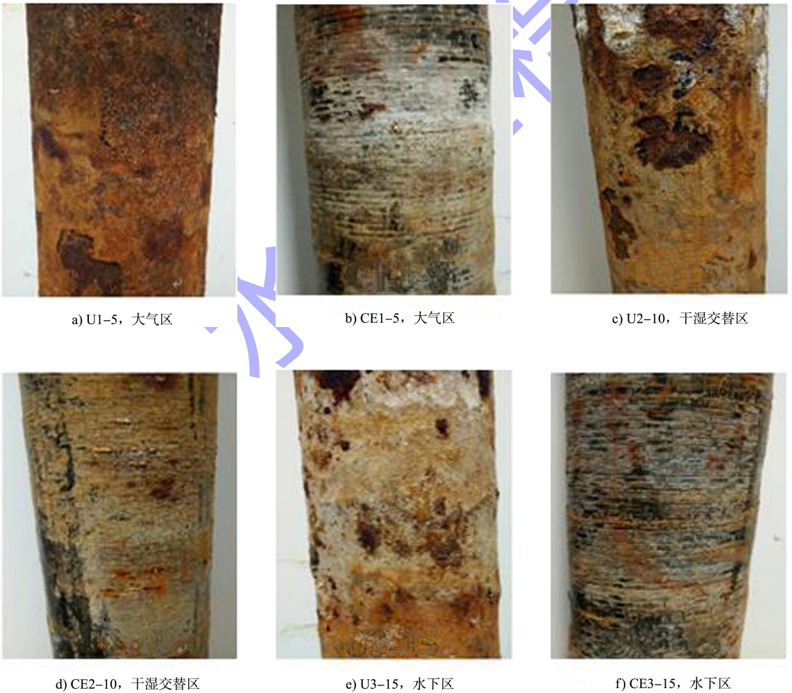
图 6 腐蚀率 15% 的模型桩锈层宏观形貌
