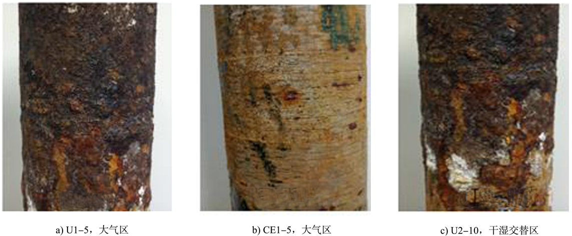
图 4 腐蚀率 5% 的模型桩锈层宏观形貌
