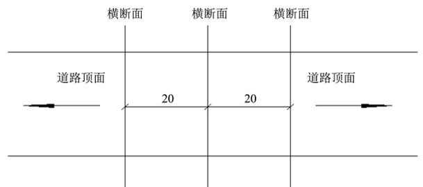
图 1 横断面测线布置 (单位: m)
