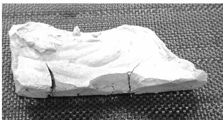
图2 吹填土烘干土样
