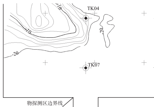
图3 港池区域基岩面高程等值线
