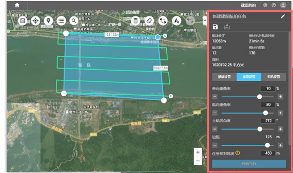
b) 无人机巡检航线规划与参数设置
