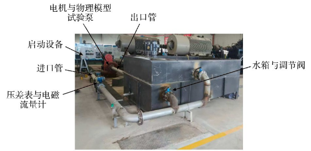
图 7 开式模型泵试验台现场布置
