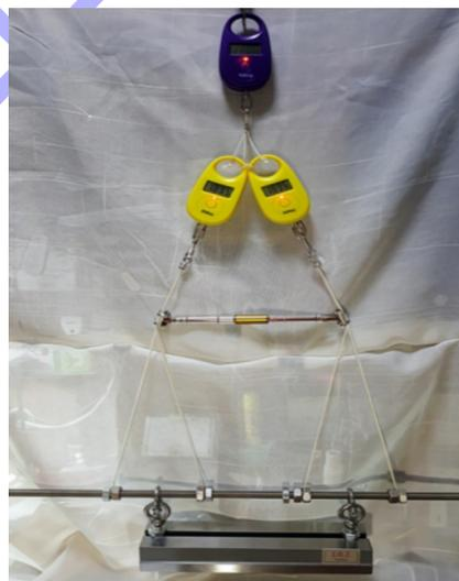
图5 吊具模型平衡状态试验
