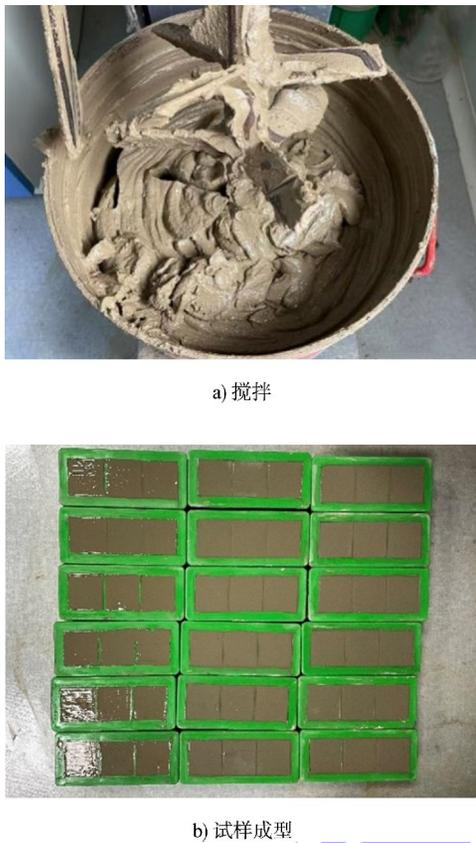
图 1 固化土体的搅拌和试样成型
