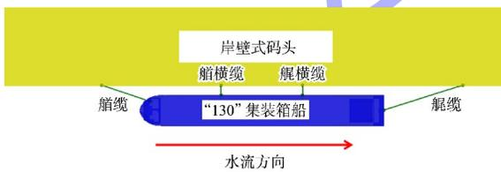
图 4 岸壁式码头系缆方式
