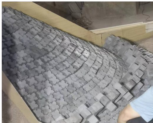
图 4 水平第 1 排 Xbloc 块体规则安放
