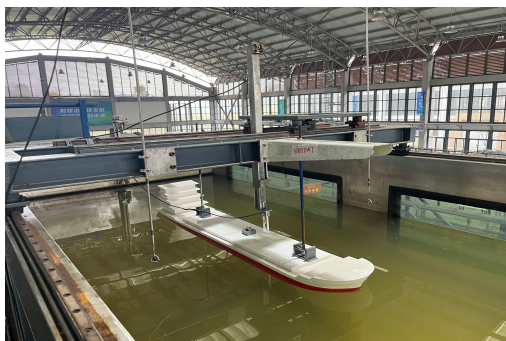
图 6 3 000 吨级船模循环水槽试验安装
