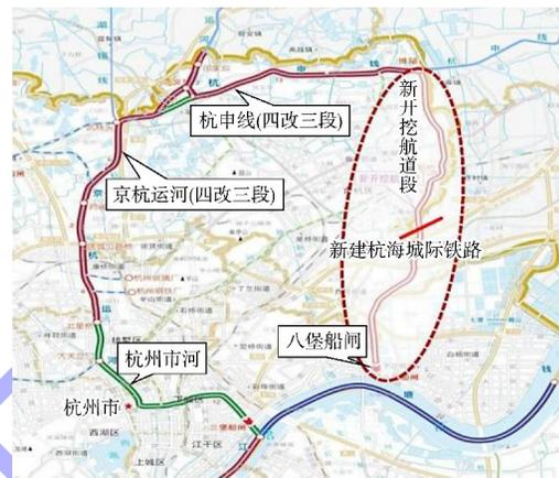
图 1 新开挖航道与杭海城际铁路线位交叉位置关系
