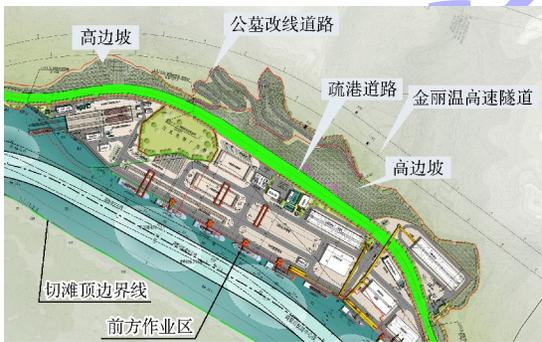
图 5 疏港道路和金丽温隧道总体平面
