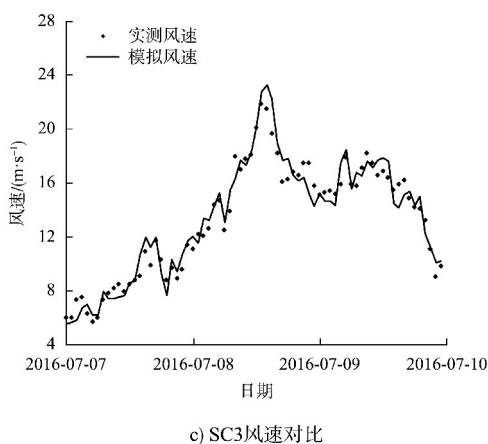
图2 模型计算风速与实测值对比
