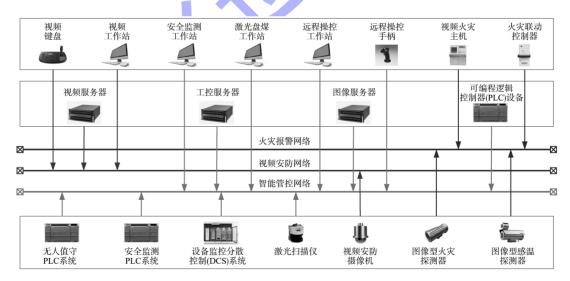
图 2 封闭煤场智能化管控系统网络结构
