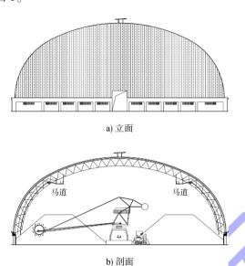
图 1 条形全封闭煤场立面和剖面
