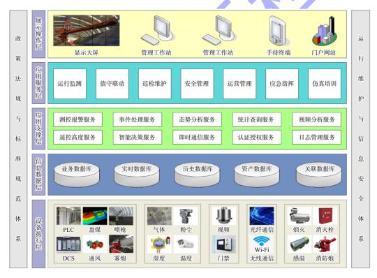
图 4 智能化管控系统总体架构
