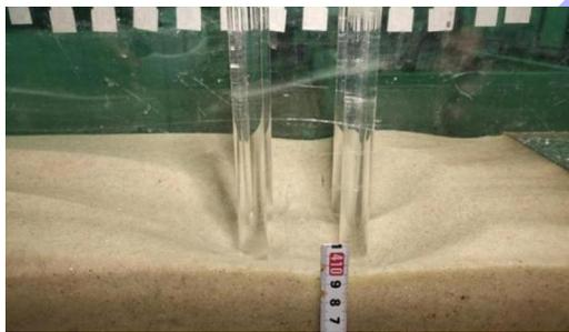
图4 T=1 800 s 水槽试验非恒定流桩群绕流局部冲刷地形
