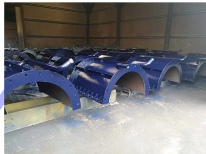
b) 防腐涂装
