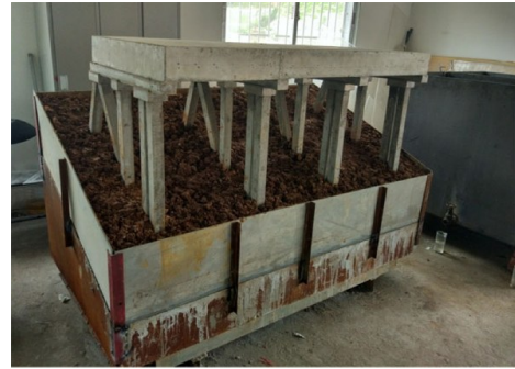
图 7 高桩码头结构试验模型
