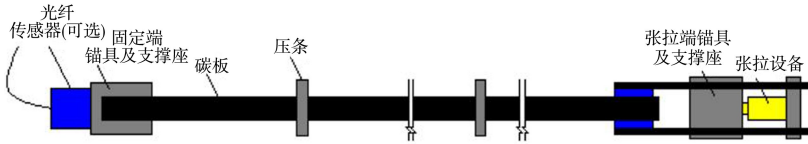
图 1 预应力碳纤维板加固系统
