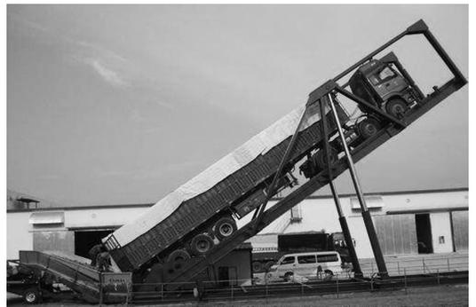
图2 汽车卸车机
