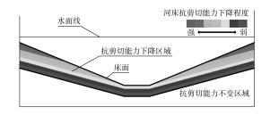
图 5 强浪作用后河床抗剪切能力变化
