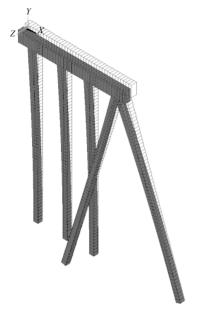
图 2 排架第一阶位移振型
