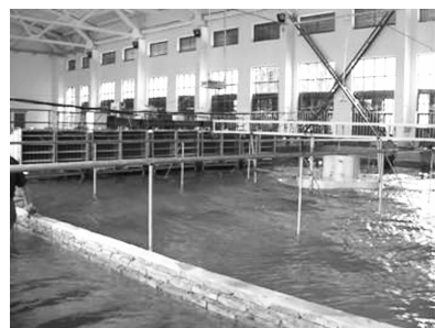
图2 波浪+水流+风的共同作用下 浮游稳定性试验(吃水7.0 m)
