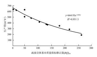
图2 [BQ]<sub>TH</sub>和疏浚生产率关系曲线
