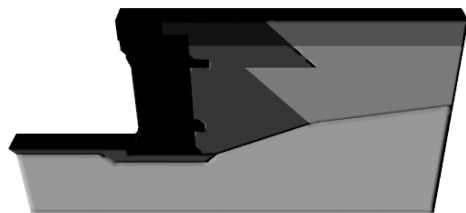
图6 沙特达曼重力式方块码头结构示意
