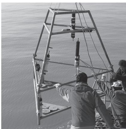
图1 坐底架观测系统仪器布置及三脚架野外释放
