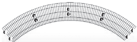
图3 支点在中心的小半径曲线桥
