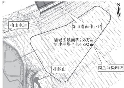
图5 围垦方案5海堤轴线布置
