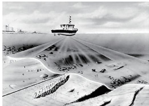
图1 多波束测深示意图
