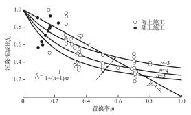
图2 沉降折减比与置换率的关系
