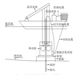
海床式静力触探系统原理
