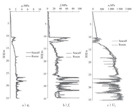
图3 不同设备试验结果曲线对比
