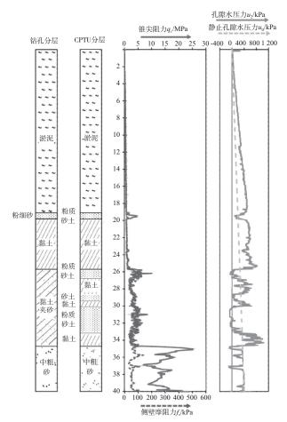
图2 钻孔分层与CPTU分层对比
