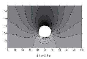
图8 隧道半径不同时的竖向位移云图
