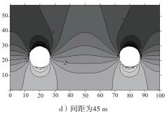
图12 两隧道间距不同时的 $U_v$ 云图
