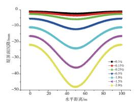
a) 隧道收缩率不同时的堤顶面沉降-水平距离关系
