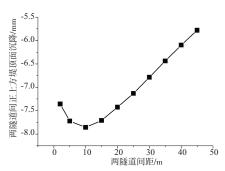
b)两隧道间正上方堤顶面沉降-间距关系
