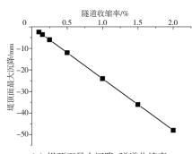
b) 堤顶面最大沉降-隧道收缩率
