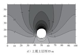
图10 隧道上覆土层厚度不同时的竖向位移云图
