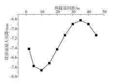
c) 堤顶面最大沉降-隧道间距关系
