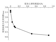
c) 堤顶面最大差异沉降-堤身土弾性模量关系 图5 堤顶面沉降-堤身弹性模量关系
