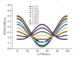
a) 隧道间距不同时的堤顶面沉降-水平距离关系
