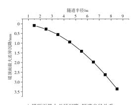
c) 堤顶面最大差异沉降-隧道半径关系 图9 堤顶面沉降-隧道半径关系
