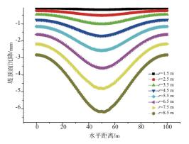
a) 隧道半径不同时的堤顶面沉降-水平距离关系
