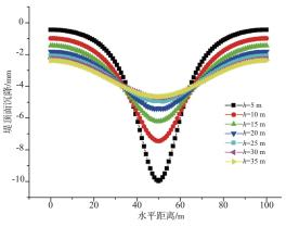
a)覆土厚度不同时的堤顶面沉降-水平距离关系
