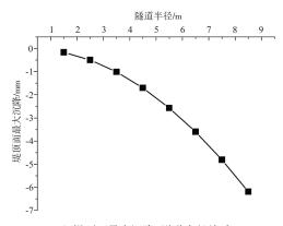
b) 堤顶面最大沉降-隧道半径关系
