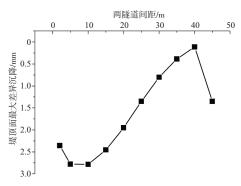
d) 堤顶面最大差异沉降-隧道间距关系 图13 堤顶面沉降-隧道间距关系
