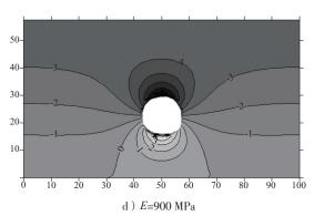
图4 堤身弹性模量不同时的竖向位移云图 (等值线上数字的单位为mm)
