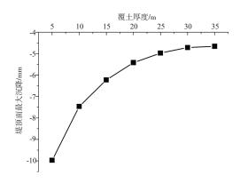
b) 堤顶面最大沉降-覆土厚度关系
