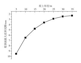
c) 堤顶面最大差异沉降-覆土厚度关系 图11 堤顶面沉降-覆土厚度关系
