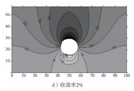
图6 隧道收敛率不同时的竖向位移云图
