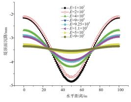
a) 堤身弹性模量不同时的堤顶面沉降-水平距离关系
