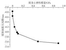
b) 堤顶面最大沉降-堤身土弹性模量关系
