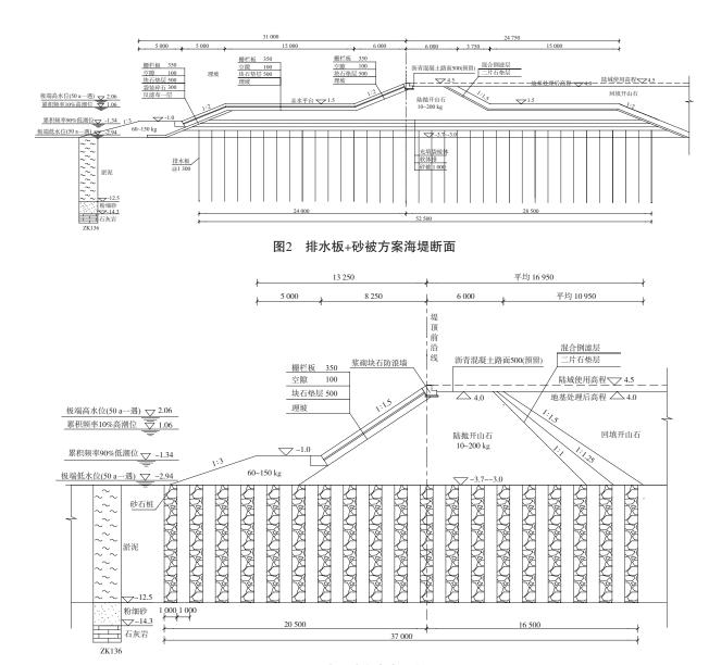
图3 砂石桩方案海堤断面
