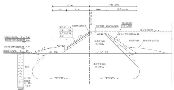
图1 爆破挤淤方案海堤断面
