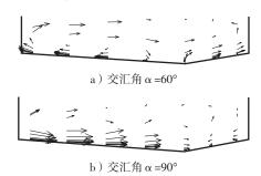
图10 汇流比λ=0.3时120° 圆心角断面环流速度矢量
