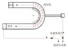
图2 弯道干支流汇合口概化模型试验系统平面布置
