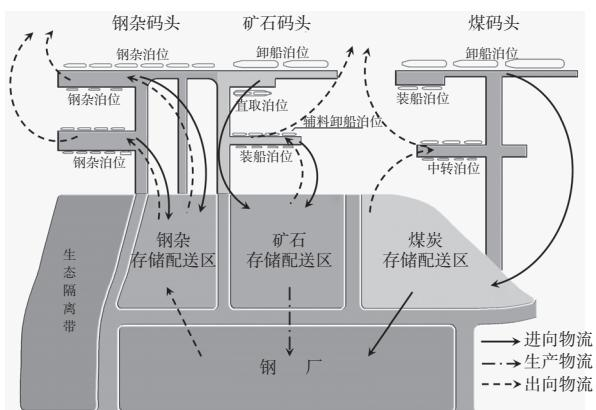
图4 罗泾港区进向物流、生产物流和出向物流流线
